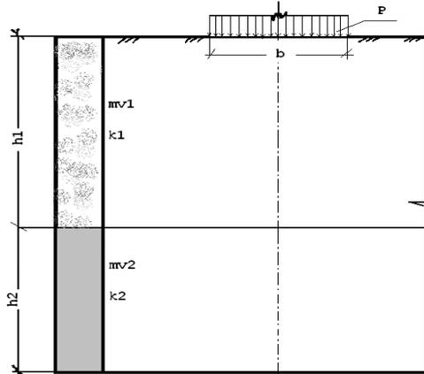
Рисунок 7 – Расчетная схема к заданию 8
